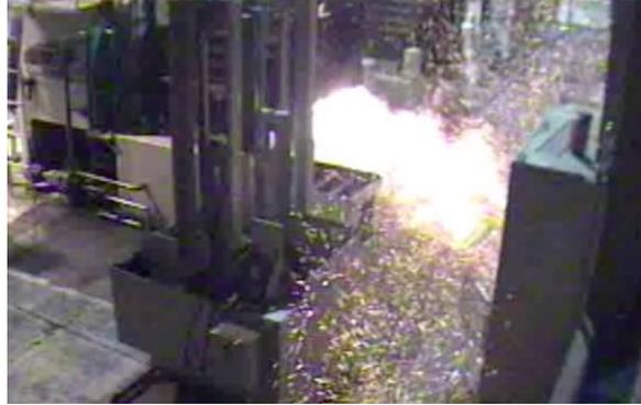
Figura 09: Momento da explosão da porta de saída da câmara de um forno SQ, devido à não abertura da cortina de chama (fonte desconhecida)
