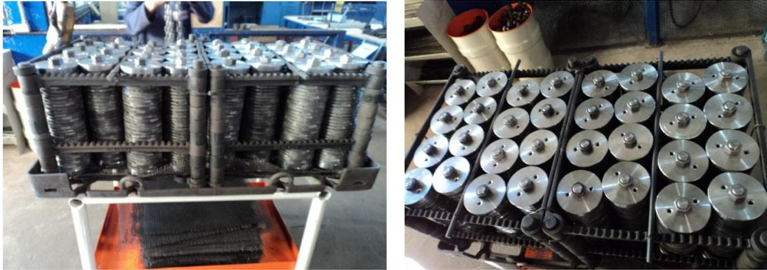
Figura 20: Detalhe da montagem de anéis para carbonitreção em dispositivos especiais (Itaraí Metalurgia)
