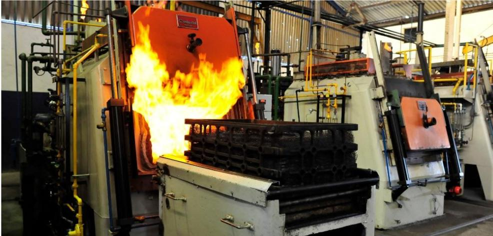
Figura 02: Fornos de atmosfera controlada do tipo IPSEN T8 (Itaraí Metalurgia Ltda)
