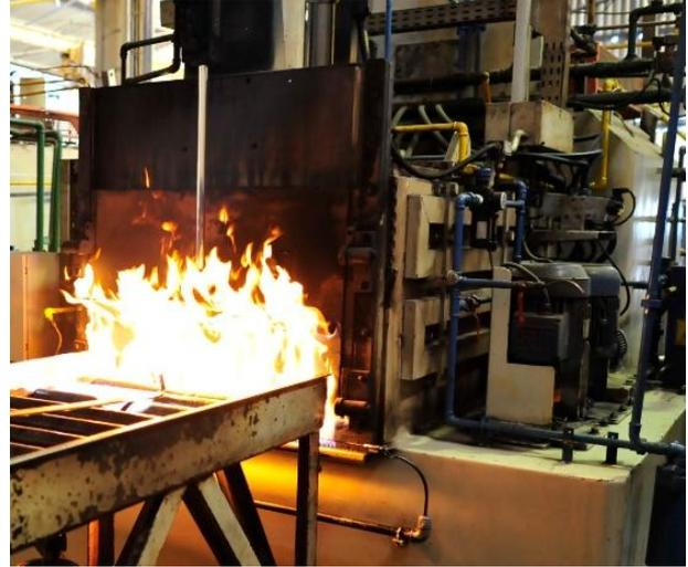
Figura 06 (esq): Detalhe de um equipamento SQ com duas câmaras e tanque de óleo integrado.
