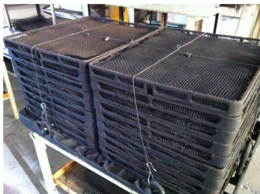
Figura 21: Detalhe de montagem de carga utilizando bandejas separadoras (Itaraí Metalurgia)
