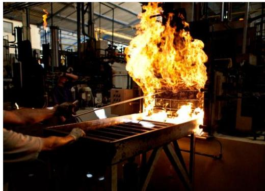
Figura 10 (esq): Detalhe do sistema de cortina de chama e queimador piloto (Itaraí Metalurgia)
