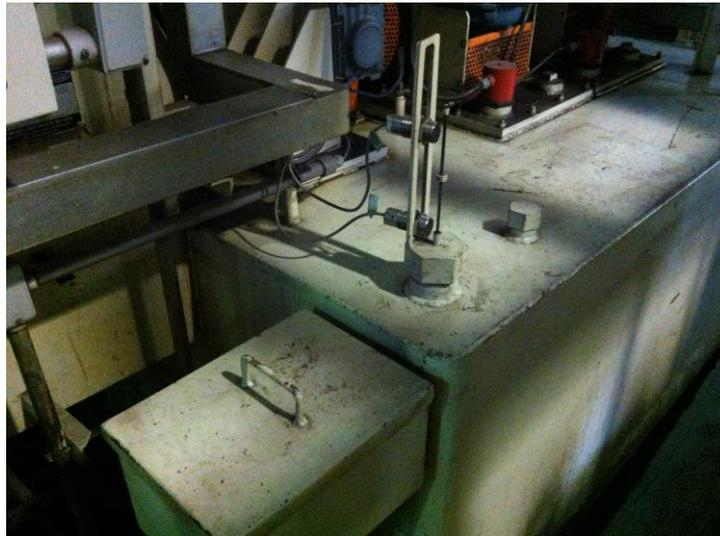
Figura 17: Detalhe do sistema de detecção do nível de óleo em equipamento SQ (Itaraí Metalurgia)
